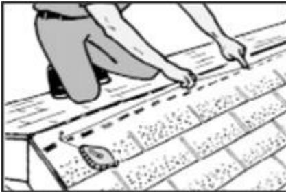
3. Используют циркулярную пилу, чтобы вырезать отверстие в кровле вдоль линии мела. От начала кровли и от стены необходимо оставить расстояние не менее 30 см. Посмотрите иллюстрацию. Регулируйте глубину пилы, так чтобы не прорезать перекрытие. Следите, чтобы пила не наткнулась на гвозди.
