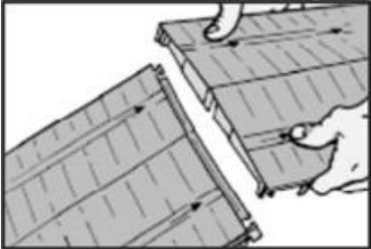
6. Устанавливаем коньковый аэратор на места, предназначенные для установки. Прикручиваем шурупом саморезы, которые идут в комплекте в местах для этого предназначенных.
