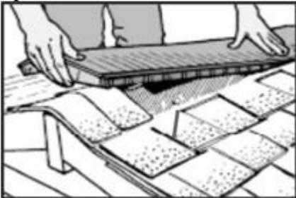
7. После того, как прикрутили конек к кровле, необходимо накрыть его кровельным материалом, который использовался в качестве основного материала для кровли. Куски должны быть по ширине не шире чем конек, чтобы не закрывать вентиляционные отверстия, и не уже конька, чтобы не нарушать эстетический вид конструкции.
