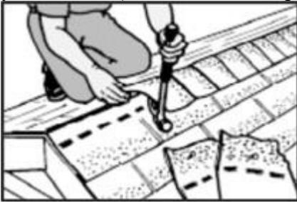
2. Для конструкции конька необходимо отметить место, где будет установлен конек, также необходимо отметить мелом или др. способом место выреза в кровле воздушных прорезей на расстоянии 1,5 см. от гребня (верхней точки стыка кровли)
